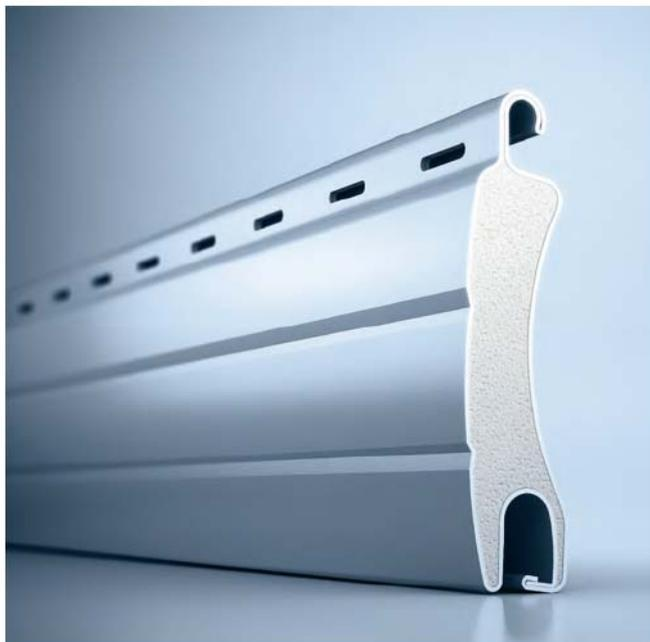
Die außergewöhnliche Materialstärke und Spezialschaummischung machen den heroal RS 37 SL zu einem konkurrenzlos hochstabilen Rolladenstab. Er erfüllt die Anforderungen der Windwiderstandsklasse 4 bei Elementbreiten bis 3.000 mm sowie die BVRs-Richtlinie TR 111 im Bereich des Einbruchschutzes.
