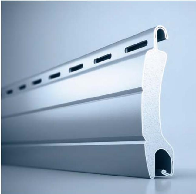
Die geringe Deckbreite von 32 mm macht den heroal RS 32 – den kleinsten Rolladenstab im System – so stark. Denn dank der kompakten Ausführung erfüllt er bei einer Elementbreite von 2.700 mm die Anforderungen der Windwiderstandsklasse 3.
