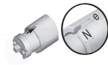
Den Antrieb dem Profil entsprechend in die Welle schieben. Achten Sie bei Verwendung eines Präzisionsrohres bitte auf die Ausklinkung für den Nocken.
