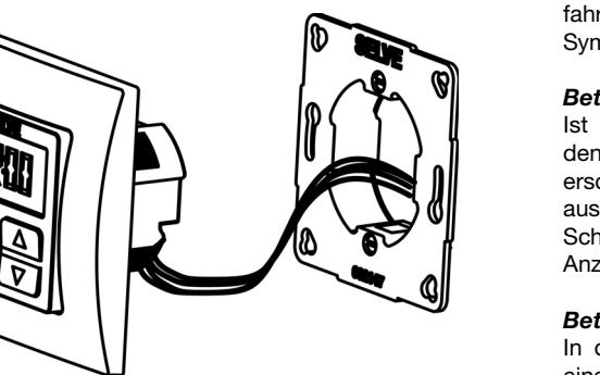
Den Halterrahmen in der UP-Dose befestigen. Das Gerät anschließen und in den Halterrahmen einstecken.
