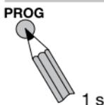
Zum Abspeichern des eingelernten Senders drücken Sie die **PROG-**Taste für 1 Sekunde. Der Sender ist jetzt dauerhaft in dem Empfänger eingelernt.
