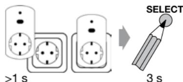
1. Die Netzspannung der Empfänger für >1 Sekunde unterbrechen. Die Empfänger können innerhalb der nächsten 4 Minuten gefunden werden.
