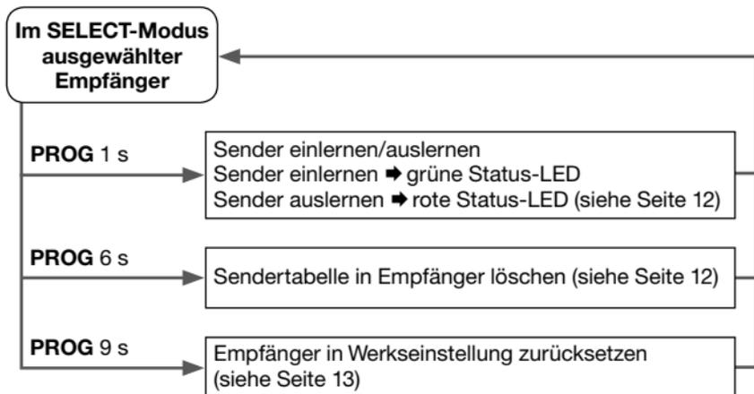
**Hinweis für Einstellungen unter Punkt 6.2.:** Der Empfänger muss für diese Einstellungen mit einem Sender im **SELECT-Modus** (Status-LED blinkt langsam orange) ausgewählt sein. Nach der Einstellung ist der Antrieb/Empfänger weiterhin ausgewählt (siehe Punkt 6.).
