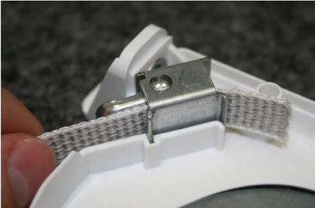
Nahaufnahme einer Hand, die den Gurt durch eine Metallklemmer in der Gehäusehälfte fädelt.                                                                                  | Den Gurt durch den Klemmer fädeln.                             |
