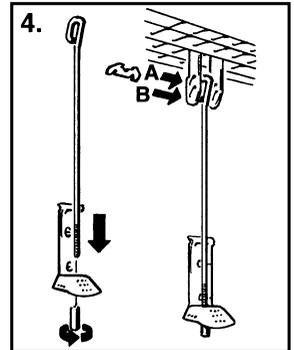
Schlitz A: für Gitterhöhe bis 35 mm     $L_1 = 250$  mm
